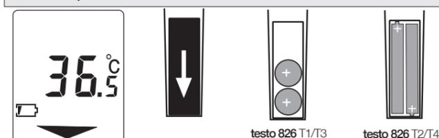
Debe cambiarse la pila. Respete la correcta polaridad de las pilas/ pilas recargables.
