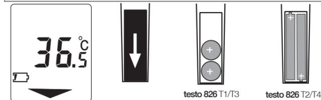
Batteriet behöver bytas. Se till att du vänder ackumulatörer/batterier rätt.
