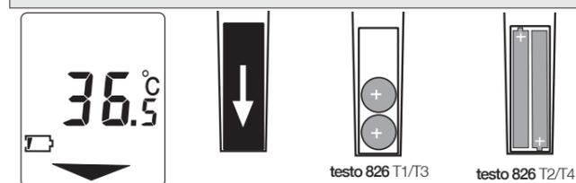
E' necessari sostituire le batterie. Controllare la corretta posizione della polarità delle batterie.
