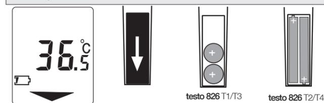
A pilha precisa ser mudada. Atenção a correcta polarização das pilhas/pilhas recarregáveis.
