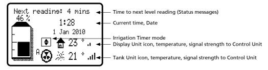
'Ĥ': Auto Mode '宀': Manual Mode : Pump On : Irrigation Timer mode off
