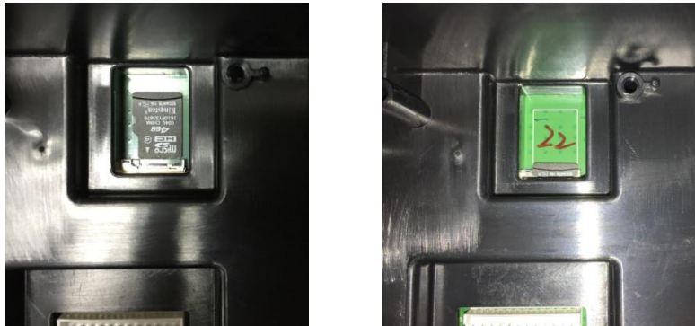
Figura 2-5 Instalando una tarjeta SD en una entrada para SD (izquierda); tarjeta SD instalada (derecha)
