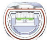
Figura 6: Posición de bloqueo de la placa de las pilas
