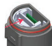
図 2: 押してロックを解除する
