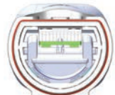
Afbeelding 6: Vergrendelde positie van batterijplaat
