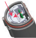
Figura 4: Empuje hacia abajo para bloquear
