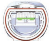
Figure 6 : position de verrouillage de la plaque du compartiment des piles
